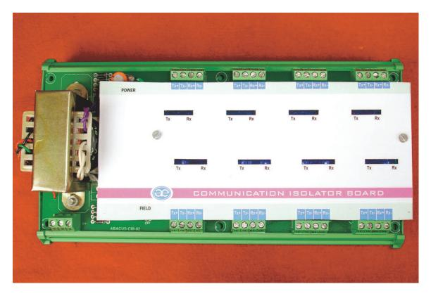
THE COMMUNICATION ISOLATOR BOARD IS HIGH SPEED RS 422/485 ISOLATOR . THE OPTICAL ISOLATION PROTECTS ONE SEGMENT OF YOUR NETWORK FROM PROBLEMS THAT ARISES ON THE OTHER. THE MODEL SUPPORTS FOR RS 422/RS 485- 4 WIRE/RS 485- 2 WIRE.( JUMPER LINK SELECTABLE).
